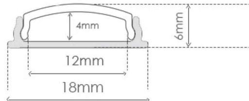
Perfil de alumínio com acrílico PMMA sobrepor flexível
