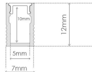
Perfil de alumínio com acrílico PMMA para sobrepor slim (fino)
