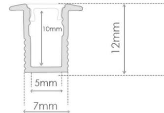
Perfil de alumínio com acrílico PMMA para embutir slim (fino)
